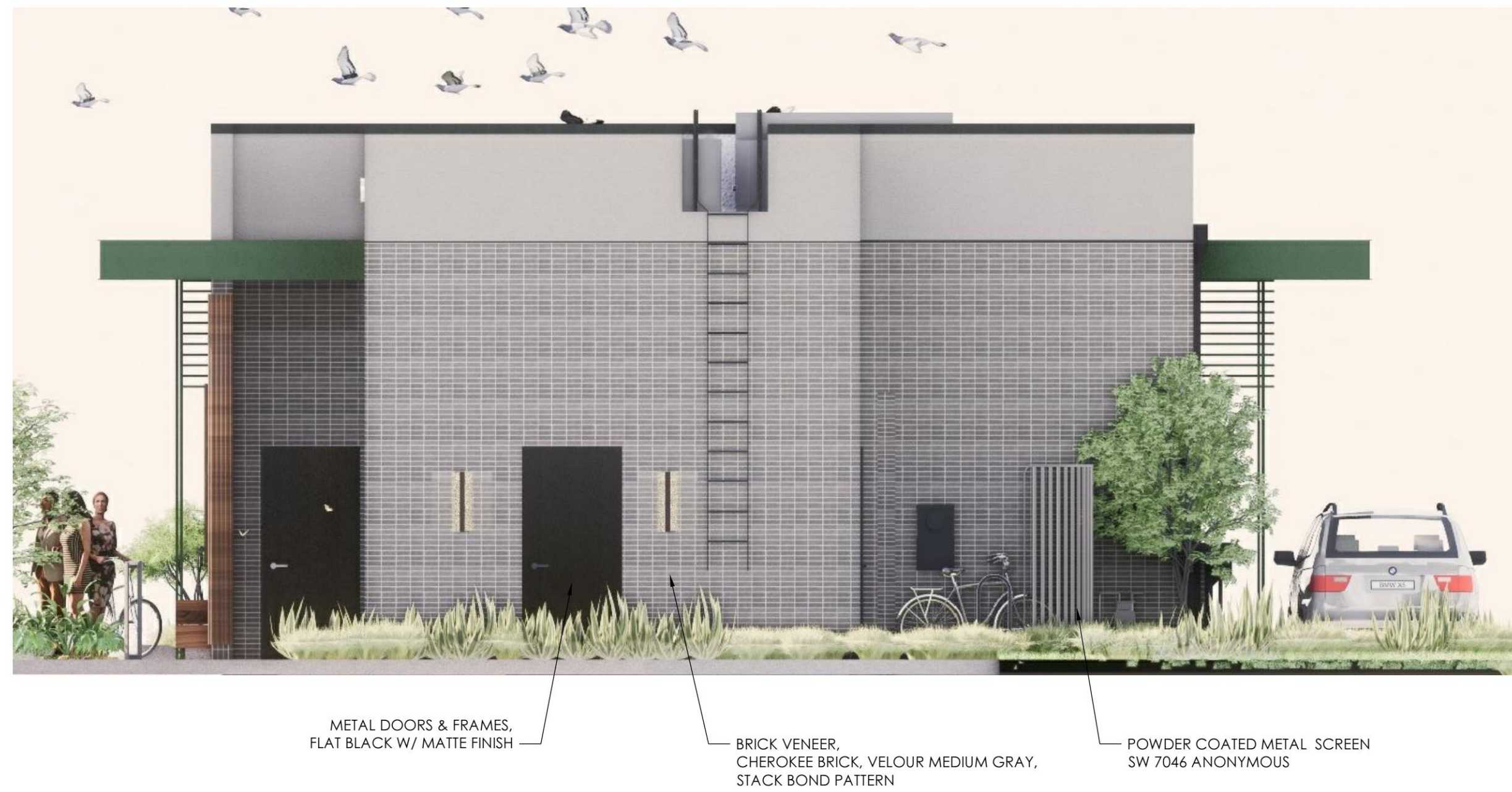
3 REAR ELEVATION A-1.1 SCALE: \frac{1}{4}" = 1'-0"
